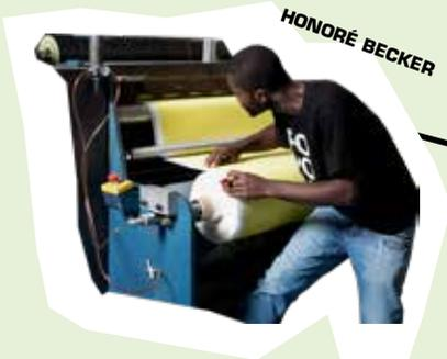
Der erste Schritt besteht darin, große Rollen (GR) zu kleinen Rollen (KR) zu schneiden. Die Anzahl der KR und ihre Breite variiert, in Abhängigkeit vom gewünschten Fell. Nachdem die KR erstellt wurde, werden diese aneinandergesetzt, um die nächsten Arbeitsschritte zu ermöglichen (der Schritt wird auch Platzierung in Trays genannt).
