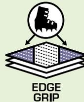
Edge Grip ist POMOCAs innovative Zwei-Komponenten-Samttechnologie, entwickelt für optimale Leistung. Durch die Verwendung einer einzigartigen Kombination von Fasern, die an den Seiten haften und in der Mitte gleiten, bietet sie eine perfekte Balance zwischen dem Grip und dem Glide. Diese Synergie bietet unvergleichlichen Halt und Gleitfähigkeit, maßgeschneidert für anspruchsvolle Gelände und anspruchsvolle Bergexpeditionen.
