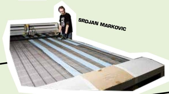
Die Rollen werden vor dem Zuschnitt auf dem Tisch des Lasers aufgewickelt. Der Zuschnitt der Felle variiert entsprechend der gewünschten Maße (Länge, Breite, Form).
