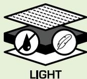
Grâce à des couches plus fines, POMOCA a réussi à alléger sa membrane classique SAFER SKIN. SAFER SKIN LIGHT (SSL) est 12% plus légère soit 150g/m<sup>2</sup> en moins. SSL rend une paire de peaux d'environ 60 à 75g plus légère tout en gardant 100% d'étanchéité.
