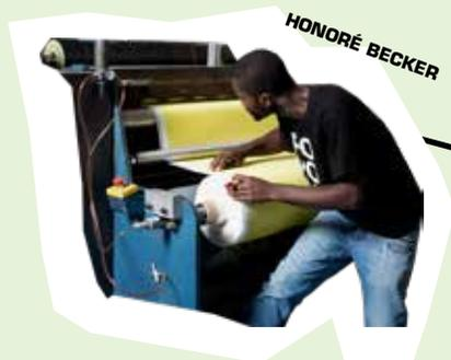
Il primo passo consiste nel tagliare il grande rotolo (GR) in rotoli più piccoli (PR). Il numero di PR e la loro larghezza varia a seconda del tipo di pelle desiderata. Una volta creati i PR, questi vengono giuntati gli uni agli altri (da estremità a estremità), passaggio chiamato anche posizionamento in strati.
