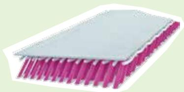
Il rivestimento crea uno strato impermeabile tra il tessuto plush e l'adesivo in modo da evitare che l'adesivo trattenga acqua e la performance venga ridotta. Un rivestimento che non sia ben impermeabile causa umidità sull'adesivo e riduce il suo tack (adesività). L'adesivo potrebbe venir via dalla pelle ed attaccarsi allo sci. Un rivestimento di qualità garantisce un corretto funzionamento dell'adesivo. Il rivestimento aumenta anche la resistenza della pelle alla lacerazione.
