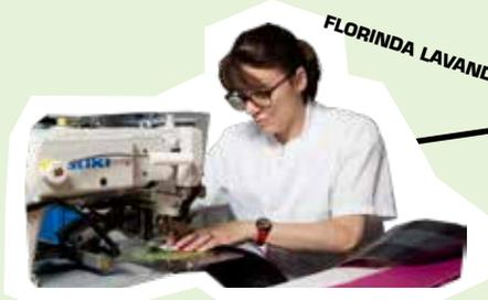
A questo punto le pelli hanno la forma desiderata, ma per essere utilizzabili, ci sono ancora alcuni passaggi da fare. Bisogna ancora assemblare i fissaggi anteriori. Questa fase è la fase di cucitura che utilizzerà diversi tipologie di materiali e metodi che variano a seconda del tipo di pelle.
