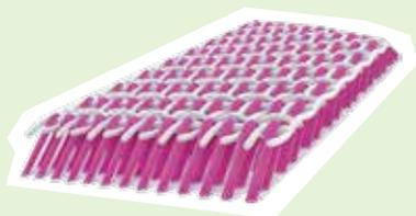
These I trattamenti di impermeabilità alle fibre, caratteristica fondamentale per prevenire la formazione di blocchi di neve. Fibre bagnate possono congelare con un cambio della temperatura. Quando le fibre congelano, attraggono la neve che si attacca alla pelle, portando alla formazione di blocchi di neve. I trattamenti migliorano anche il fissaggio delle fibre, la loro angolazione e il loro rivestimento, attributi importanti per la durata e lo scioglimento/presa.
