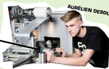
Auch hier werden die KR ausgerollt und bilden einen langen Streifen auf der Unterseite des Fells, auf dem sich zwei verschiedene Schichten Klebstoff befinden.
