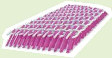
Die Veredelung macht die Fasern wasserresistent und verhindert dadurch Stollenbildung. Gleichzeitig werden die Fasern ausgerichtet, geglättet und fixiert. Dies steigert die Haltbarkeit, Gleitfähigkeit und die Haftung.
