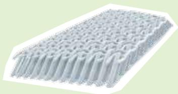
Il tessuto plush offre presa e scorrevolezza alla pelle. Queste caratteristiche variano a seconda del materiale usato (nylon, materiale misto, mohair) e a seconda del modo in cui le fibre sono tessute (più spesse o più sottili, più lunghe o più corte, più o meno angolate). Normalmente una pelle che scivola di più, ha una minore presa.
