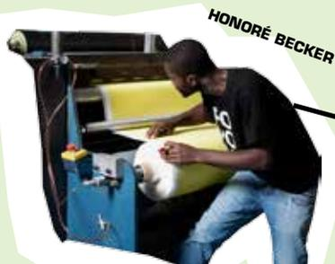
Il primo passo consiste nel tagliare il grande rotolo (GR) in rotoli più piccoli (PR). Il numero di PR e la loro larghezza varia a seconda del tipo di pelle desiderata. Una volta creati i PR, questi vengono giuntati gli uni agli altri (da estremità a estremità), passaggio chiamato anche posizionamento in strati.
