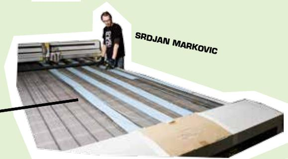
Les petits rouleaux sont déroulés sur la table du laser avant d'être découpés. La découpe des peaux varie en fonction des dimensions souhaitées (longueur, largeur, forme).
