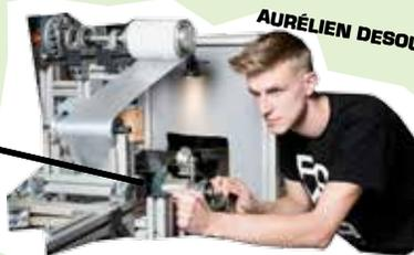
Ici encore, les PRL sont déroulés et forment une longue bande sur laquelle le dessous de la peau se voit déposer deux couches de colles différentes.
