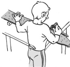
3. Ruotate lo sci in modo che il secondo lato della pelle da tagliare sia opposto a Lei. La taglierina asporterà la pelle in eccesso lasciando esattamente scoperta la lamina dello sci per una larghezza di 2 mm.
