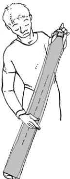
2. Coloque el esquí sobre una superficie estable, a ser posible un sistema especializado. Utilice el cíter POMOCA para cortar el trozo de piel que sobresale del canto del esquí opuesto a usted, comenzando por la punta del esquí. El cíter corta exactamente a 2mm del canto, dejando este visible.
